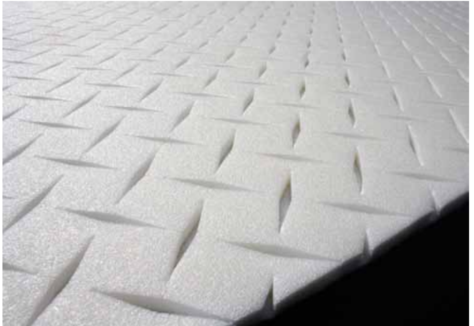
Leveranciers van shockpads hebben hun eigen methodes om de shockpad minder gevoelig voor krimp of uitzetting te maken.
