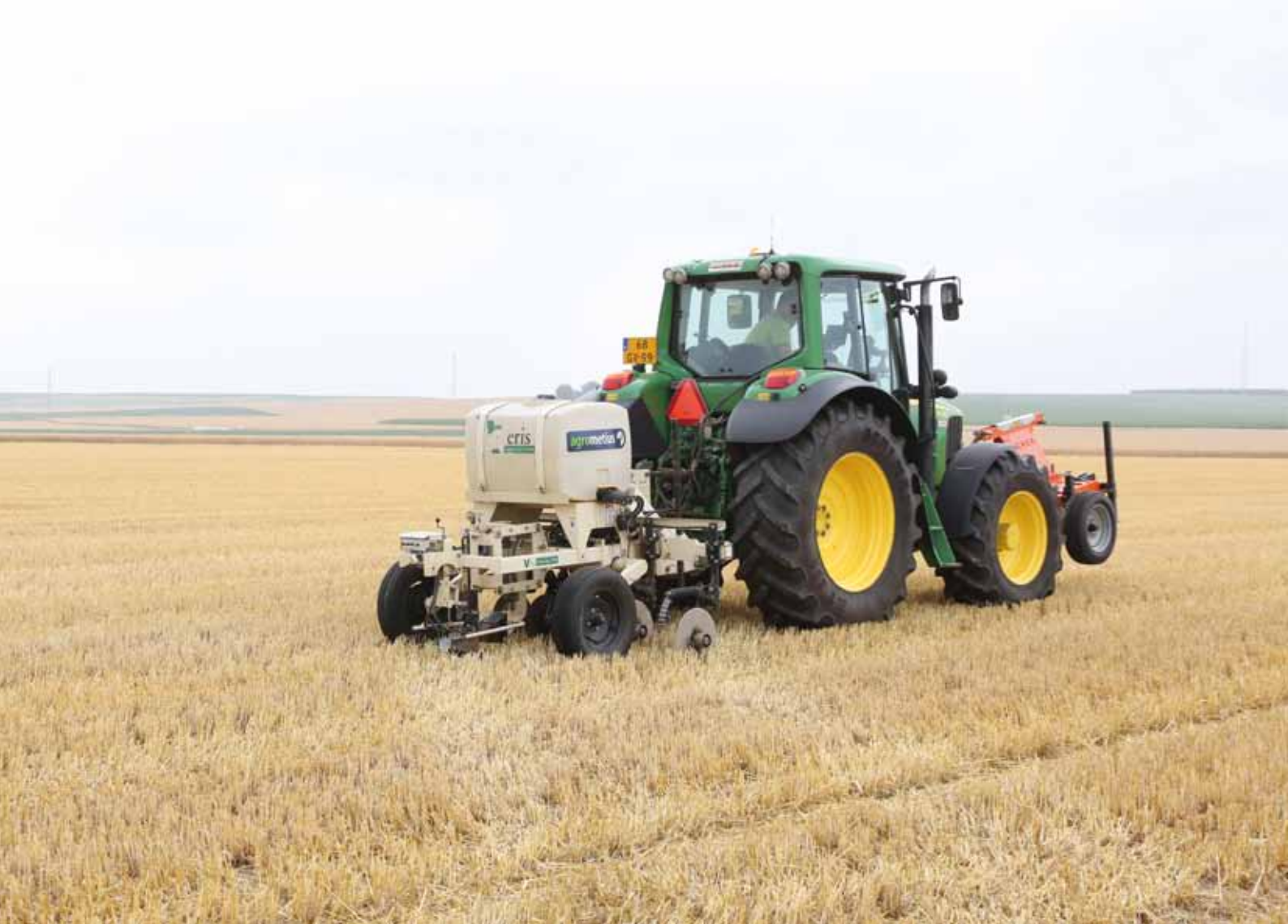
Een bodemscan maken met de Veris MSP3. Voor een vaste prijs per hectare verzorgt een loonwerker samen met Agrometius en Agrifirm het volledige programma.
