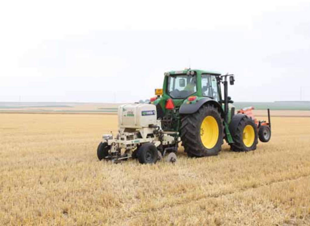
Een bodemscan maken met de Veris MSP3. Voor een vaste prijs per hectare verzorgt een loonwerker samen met Agrometius en Agrifirm het volledige programma.
