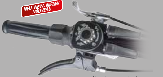
Draaiknop voor traploze snelheidsregeling vooruit en achteruit
