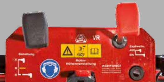
Overzichtelijk bedieningspaneel, hoogteregeling stuur en schakelschema
