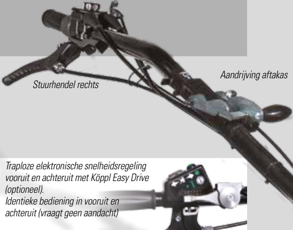
Draaiknop voor traploze snelheidsregeling vooruit en achteruit
