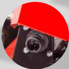
Contactdoos voor aanbouwapparaten voor het aankoppelen van elektrisch bestuurbare aanbouwapparaten
