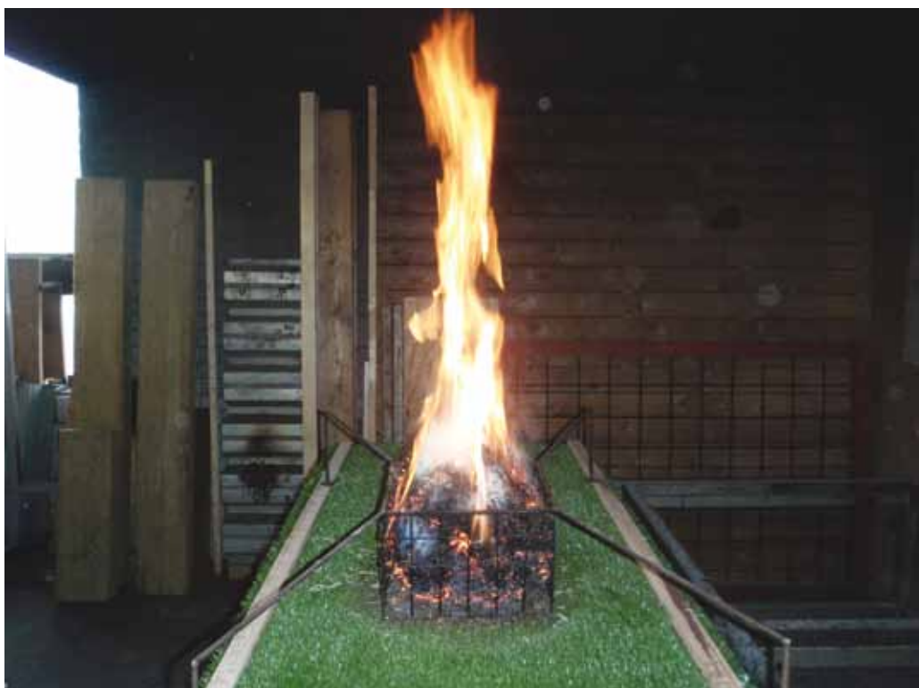
Bij de vliegvuurtest wordt gekeken naar de brandgevoeligheid van het kunstgras.
