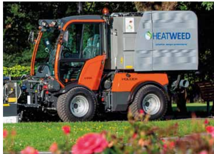
Heetwatermethode. Op de foto: Heatweed
