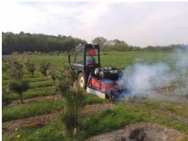
Aangepaste Hoaf-Weedstar 100 als intra-rijbrander bij boomkwekerij Parasolboom.
