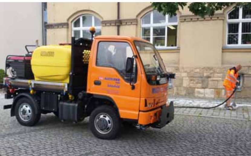
De heet water-/schuimmethode van Iprogreen.
