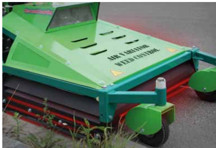
Onkruid branden met hete lucht. Op de foto: Air Variator.
